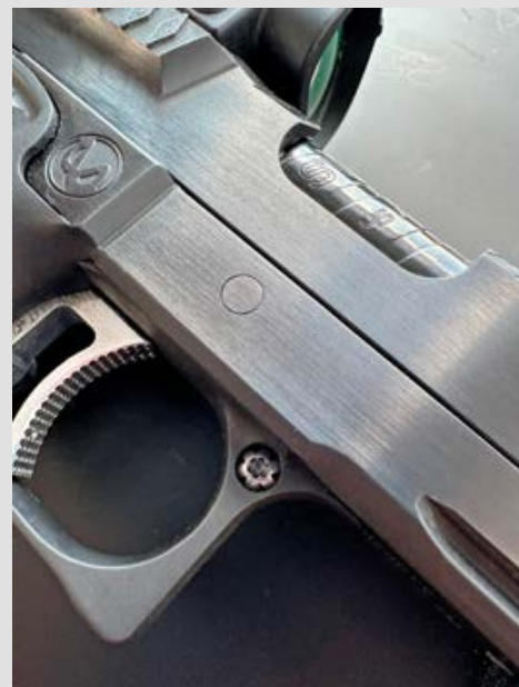
Die liebevollen Details unterstreichen die Exklusivität: Flacher Skeletthammer, der sauber im Griffstück positionierte Verschlussfanghebel oder die Montageschrauben für das Leuchtpunktvisier. (Fotos: Tino Schmidt)
