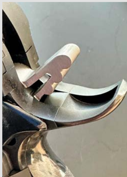
Die liebevollen Details unterstreichen die Exklusivität: Flacher Skeletthammer, der sauber im Griffstück positionierte Verschlussfanghebel oder die Montageschrauben für das Leuchtpunktvisier. (Fotos: Tino Schmidt)
